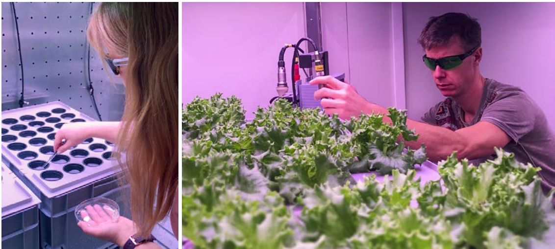
Figur 2: Laboratorieforsøk hos Senter for tverrfaglig forskning i rommet (CIRiS). Salat dyrkes i en vann og næringsløsning med og uten avrenningsvann fra et kommersielt settefiskanlegg. Alle foto: CIRiS, NTNU Samfunnsforskning.
